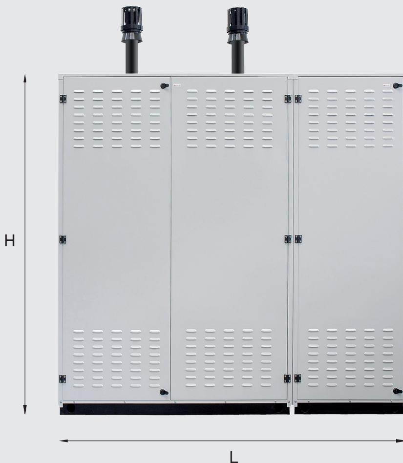
Il RoofBox base comprende, oltre all'armadio (senza i laterali), i collettori di mandata e ritorno impianto isolati in acciaio con valvole 3vie, i collettori gas in acciaio, tubazioni scarico condensa, sonde cascata, sonda esterna, sonda bollitore (bollitore esterno), e i tubi fumi per uscita verticale in PPS DN80.
