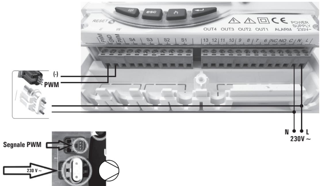
ESEMPIO DI COLLEGAMENTO PER CIRCOLATORI SOLARI A 3 VELOCITA' CON ROTORE BAGNATO OPPURE "HIGH EFFICIENCY", CONFORMI ALLA DIRETTIVA ErP 2015, CHE NON NECESSITANO DI SEGNALE PWM ESTERNO (SENZA CONNETTORE PER PWM).
