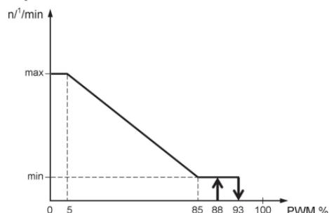
Le pompe collegate sulle uscite PWM E e/o PWM W funzionano secondo lo standard "PWM1", mediante la logica di riscaldamento, anche detta invertita. Con il segnale PWM generato al minimo valore (0%) la pompa gira alla massima velocità, mentre con il segnale PWM generato al massimo valore (100%) la pompa gira alla minima velocità. Ovviamente
