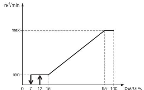
Le pompe collegate sulle uscite PWM E e/o PWM W funzionano secondo lo standard "PWM2", mediante la logica solare, anche detta normale.
