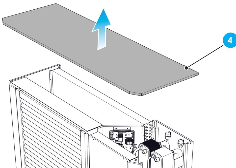
una volta rimosso il pannello (1) è possibile accedere al quadro elettrico (5);
