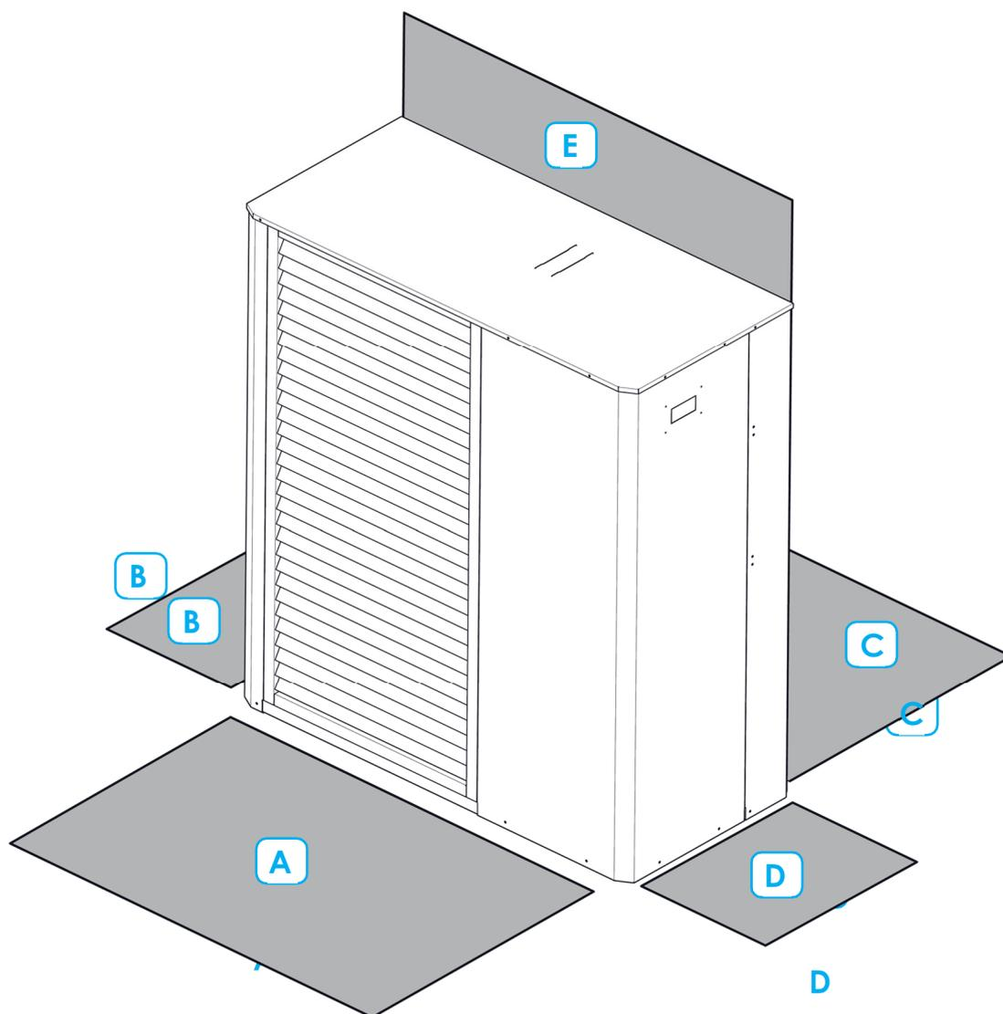
L'installazione della macchina deve permettere al personale specializzato ed autorizzato di poter intervenire, in caso di manutenzione, in maniera agevole rispettando sia le distanze di sicurezza tra le unità e le altre apparecchiature che gli spazi tecnici indicati in tabella.
