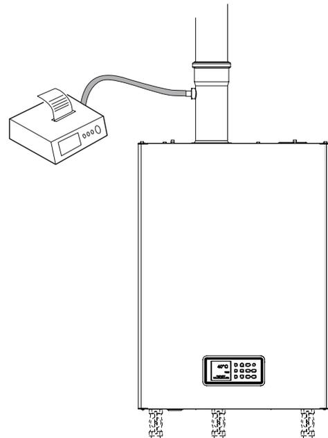
Nel caso i valori di CO<sub>2</sub> non corrispondano, agire gradualmente sulla vite di regolazione gas MAX posta sulla valvola gas fino a rilevare sull'analizzatore i valori di combustione corretti.
