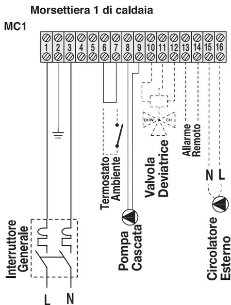
I modelli Multiparva 3.0 N sono caratterizzati dall' assenza del circolatore interno ma è comunque possibile installarne uno in un secondo momento o installare un circolatore esterno. Infatti l'alimentazione del circolatore in questi modelli è stata ricablata sulla morsettiera di caldaia dove due morsetti sono dedicati al collegamento di fase - neutro del circolatore.
