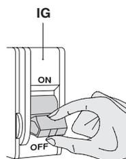
Prima di iniziare le operazioni di riempimento e svuotamento dell'impianto posizionare l'interruttore generale (IG) dell'impianto su "OFF-speinto".
