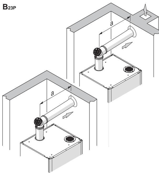
Calcolo della lunghezza massima per installazioni tipo B<sub>23P</sub> con tubi di Propilene liscio o acciaio inox liscio.
