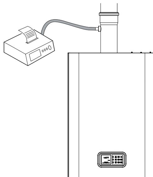
Nel caso non corrispondano, agire gradualmente sulla vite di regolazione gas MAX posta sulla valvola gas fino a rilevare sull'analizzatore i valori di combustione corretti.
