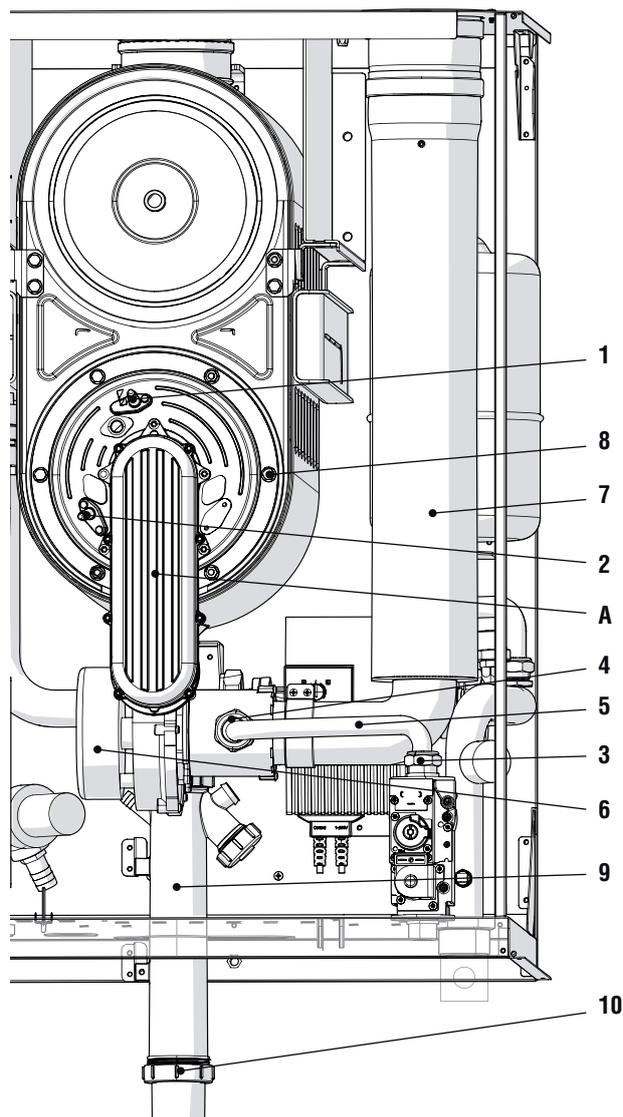
Il bruciatore non necessita di una particolare manutenzione, ma è sufficiente spolverarlo con un pennello in setola. **Manutenzioni più specifiche saranno valutate ed eseguite dal Tecnico del Centro Assistenza Autorizzato.**
