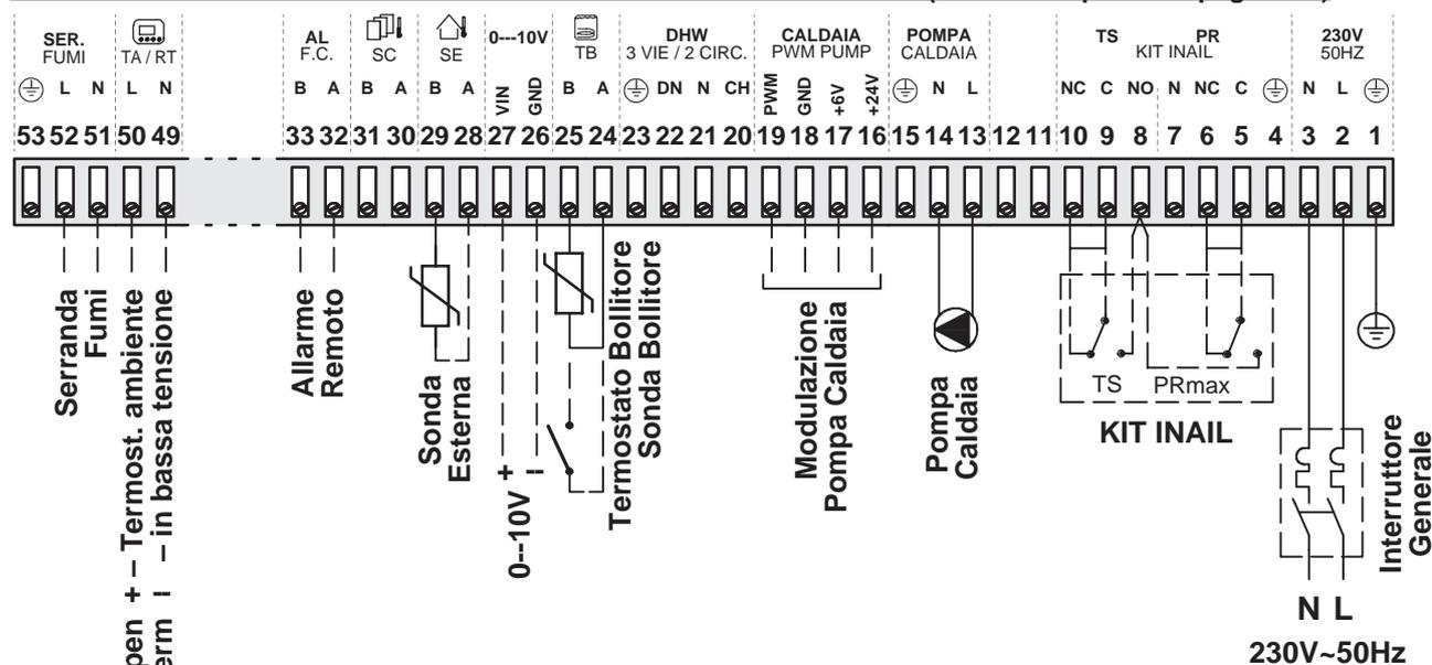
(\*) La pompa di cascata (34-35), la pompa bollitore (21-22) e la seconda pompa di riscaldamento (20-21) devono essere collegate ai contatti elettrici della caldaia tramite relè inoltre, con caldaie in cascata la pompa bollitore (21-22) e la seconda pompa di riscaldamento (20-21) devono essere collegate in parallelo con tutti i generatori presenti nella sequenza di cascata.
