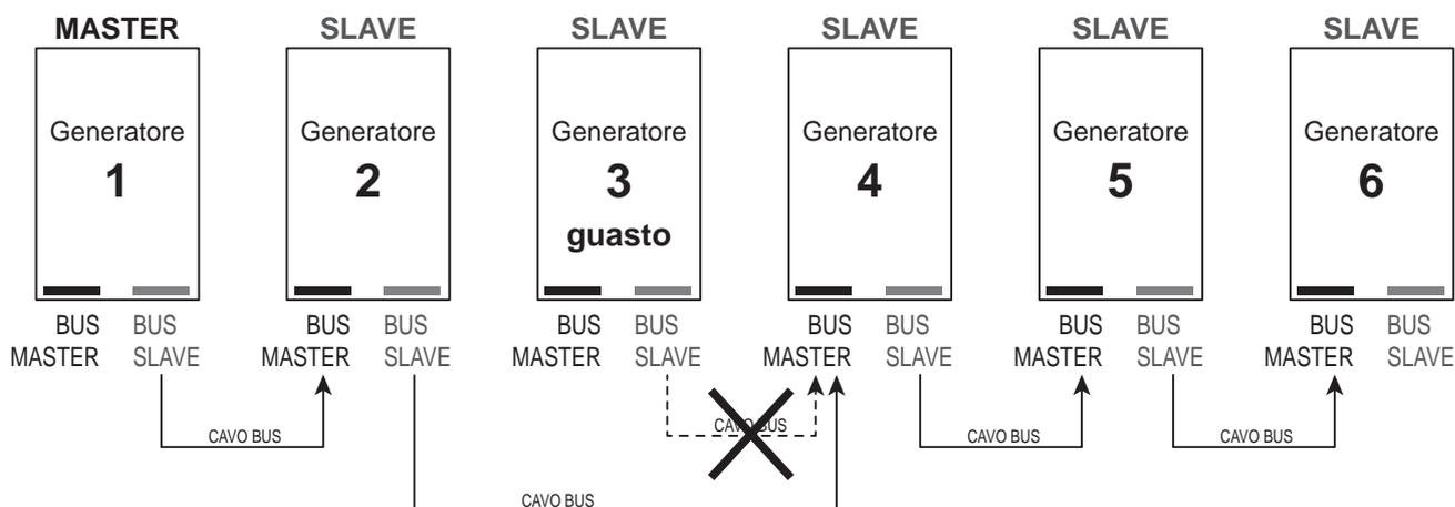
Per isolare, e quindi escludere dalla sequenza di cascata, il generatore da riparare sarà sufficiente collegare in serie il generatore precedente con quello successivo, mediante collegamento (BUS).
