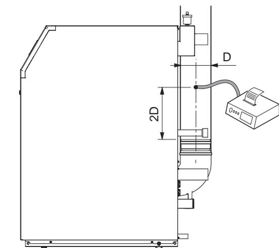
Nel caso non corrispondano, agire gradualmente sulla vite di regolazione gas MAX posta sulla valvola gas fino a rilevare sull'analizzatore i valori di combustione corretti.
